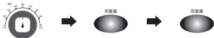
• 오븐의 내부온도가 설정온도에 도달하면 내부열선 및 작동중 램프가 꺼지고 내부온도가 떨어지면 다시 내부열선 및 작동중 램프가 들어옵니다. [내부온도가 설정온도인 200℃를 도달하여 램프가 꺼진 예] [램프가 꺼지고 내부온도가 떨어져서 작동중 램프에 불이 들어온 예]
