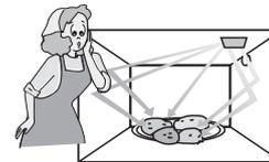
지금까지 사용해오던 조리 기구에 혁신을 가져온 전자레인지는 마이크로(MICRO)파라고하는 초고주파를 이용하여 음식을 조리하는 조리기구입니다. 음식 내부에 있는 물분자에 고주파가 흡수되면 마찰열을 일으키는데 그 열에 의해 음식이 익게 됩니다. 기존의 조리 기구처럼 외부에서 가열되는 것이 아니고 음식내부에서 발생하는 마찰열로 익히므로 영양소 파괴가 거의 없고 매우 짧은 시간에 조리되므로 본래의 맛과 영양뿐만 아니라 색까지 그대로 유지시켜 줍니다.
