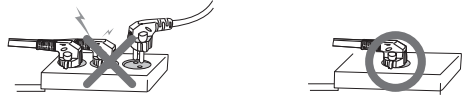
해당모델은 16A이상의 전용선이 필요합니다. 만일 전용선이 설치되지 않은 경우에는 필히 전원공사를 해야만 합니다.(전원공사는 전기공사업 허가업체에서 시공해야만 합니다.)
